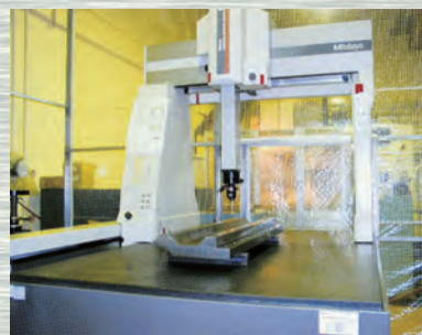
高品質を維持するための三次元測定機 3D measuring instrument for maintaining high quality
